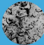
鑄鉄の黒鉛分布状態 顕微鏡写真
