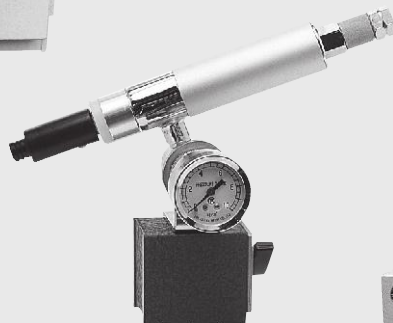
エアークーラー コンプレッサーエアーを 供給するだけで-65℃ (温度差)の冷気を発生
