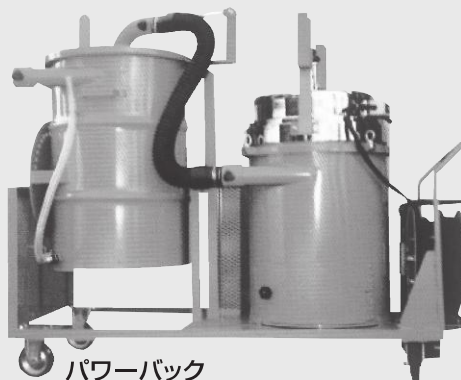
エアパール コンプレッサーエアーを使用する バキュームクリーナー。パール缶 がそのままDry&Wet兼用
