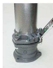
⑤ グリップ用ボルト、及びナットをワッシャと共に装着し、標準トルクで締め付けます。
