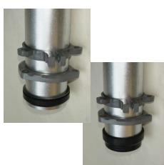
① 管にグリップ、継手フランジロックパッキン（クッションパッキン）の順に装着します。
