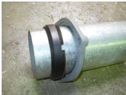
③フランジ、ロックパッキンを装着した管端を継手受け口部に差し込んで下さい。
