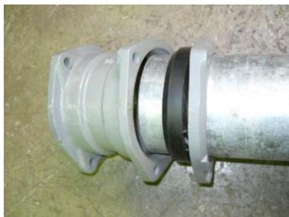
熱膨張による管の伸びに対応する場合には、継手と管の間に 3mm 程度の隙間を設けることを推奨します。
